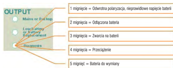
Rys. 4) Sygnalizacja stanu baterii urządzenia podczas awarii lub błędu.
