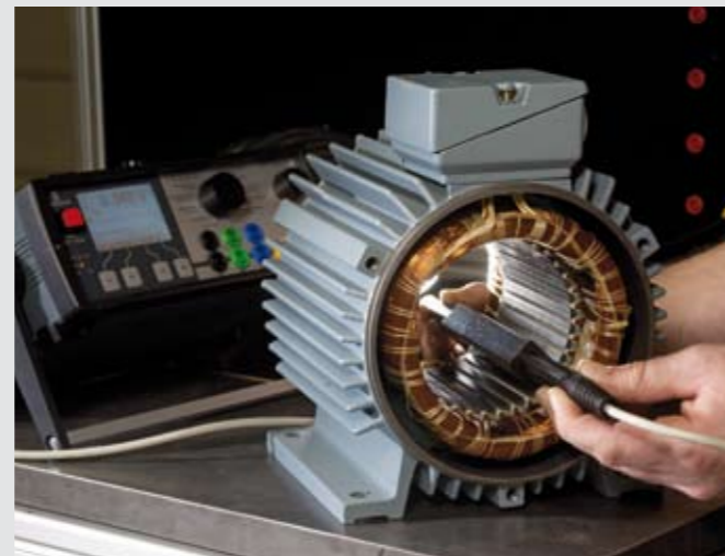
Poszukiwanie zwarcia w uzwojeniu stojana metodą indukcyjną
